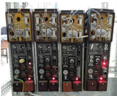
Рис.35. Модули: а) связи; б) ввода вывода; в) управления тэнами; г) управления насосом; д) преобразования температур
