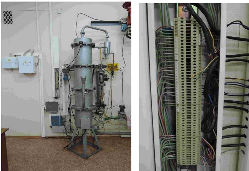
Рис.47. Общий вид установки (слева) и соединительной коробки (справа)
