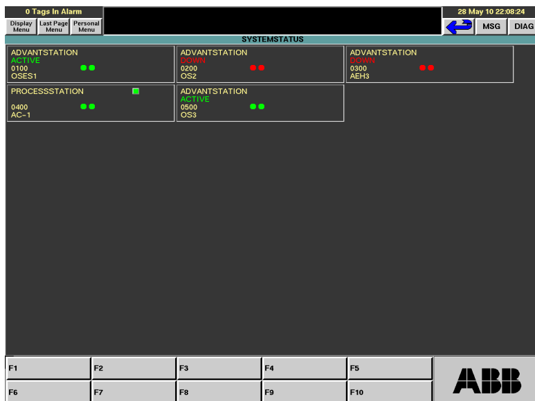
Рис. 16. Окно «SystemStatus», отображающее контроллер и операторные станции, участвующие в регулировании технологического процесса
